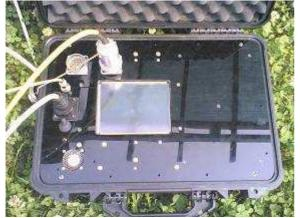
L'intero processo comprende tre passi successivi: L'acquisizione delle onde superficiali (ground roll), la costruzione di una curva di dispersione (il grafico della velocità di fase rispetto alla frequenza) e l'inversione della curva di dispersione per ottenere il profilo verticale delle Vs.
