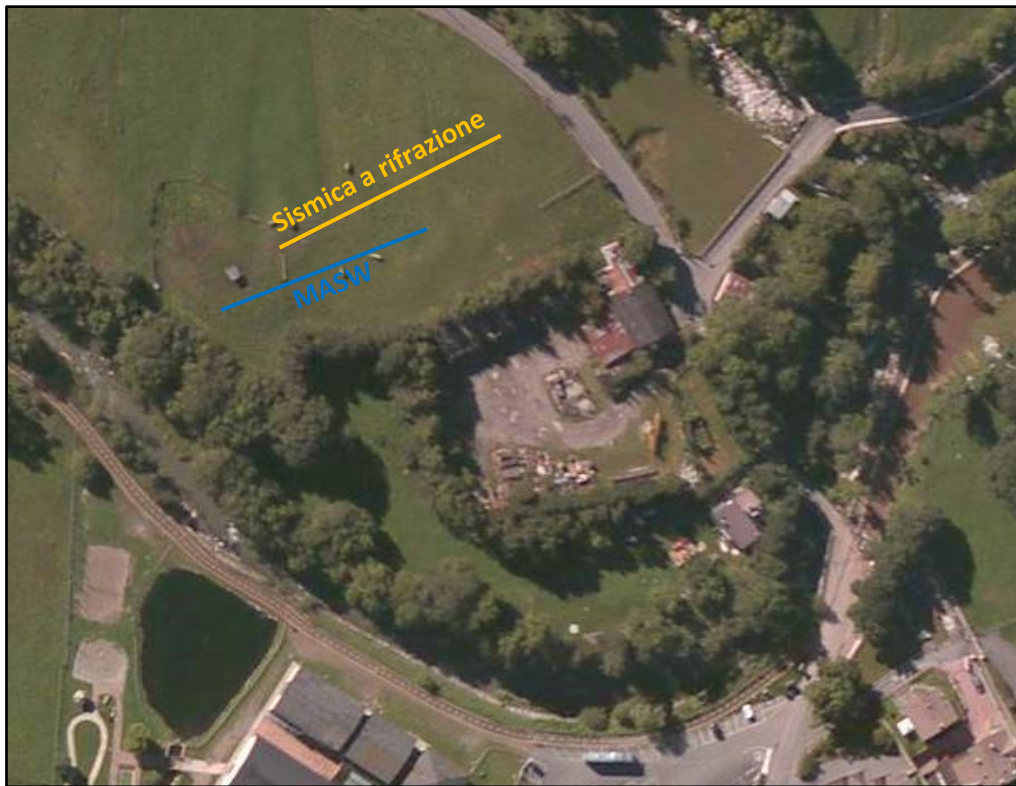
Figura 3.2: Ubicazione stendimenti sismici.
